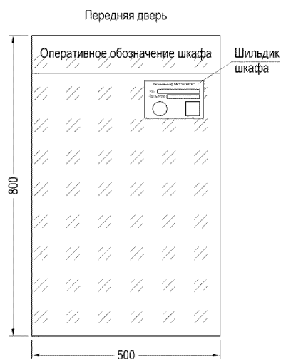
Рисунок 4.3.2 - Общий вид обзорной двери типового шкафа ШЭТ ПДС НСП и КПЗ
