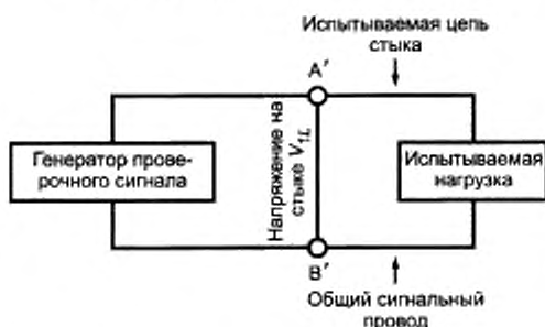
Рисунок 4 — Испытательная схема для измерения нагрузки V.10
