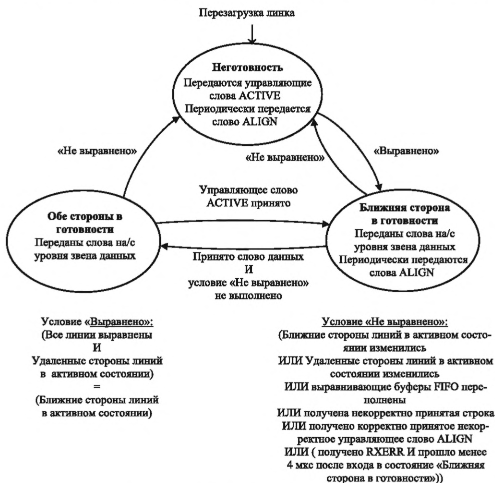
Рисунок 9.7 — Диаграмма состояний машины состояний выравнивания
