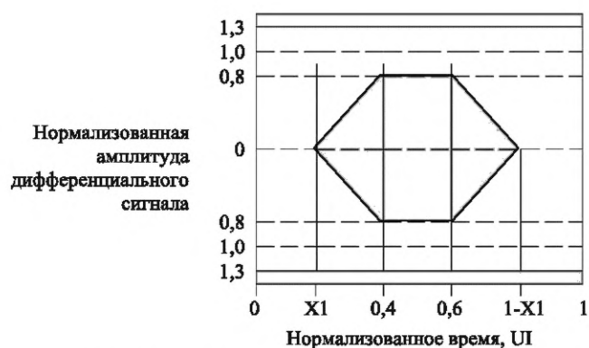
Рисунок 7.13 — Электрооптическая маска глазковой диаграммы передатчиков, предназначенных для работы в диапазоне битовых скоростей от 1 до 5 Гбит/с
