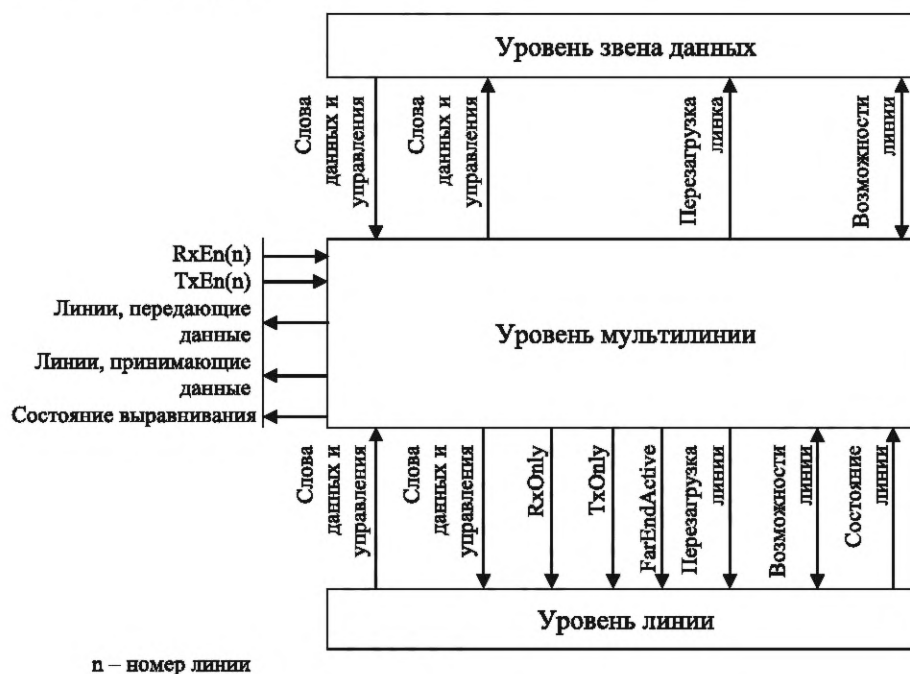
Рисунок 9.1 — Интерфейсы уровня мультилинии
