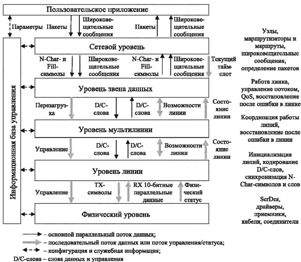
Рисунок 5.2 — Стек протоколов SpaceFibre-RUS для линка с мультилинией
