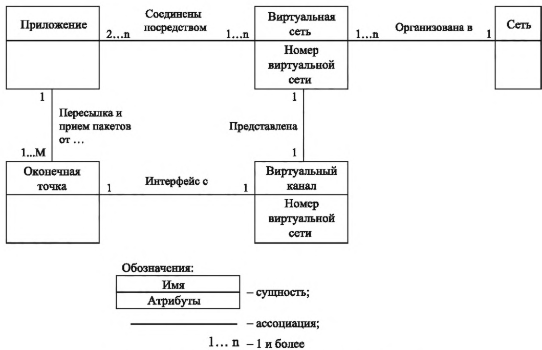
Рисунок 11.3 — Связи внутри виртуальной сети SpaceFibre
