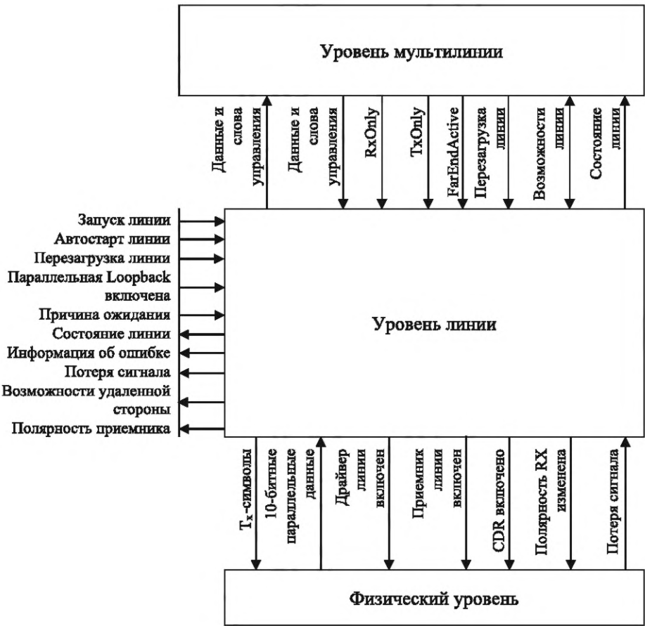
Рисунок 8.2 — Интерфейсы уровня линии для линка с мультилинией
