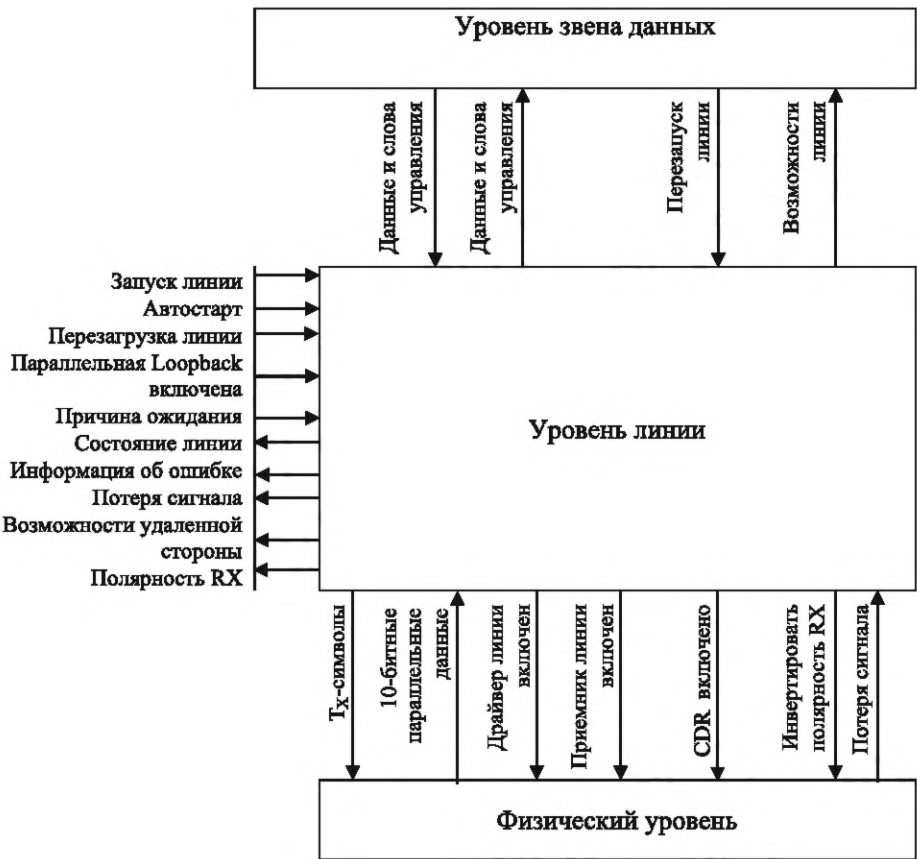
Рисунок 8.1 — Интерфейсы уровня линии для линка только с одной линией
