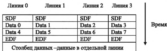
Рисунок 9.4 — Распределение данных по линку мультилинии
