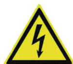
а) «Опасность поражения электрическим током» (W08 ГОСТ 12.4.026)
