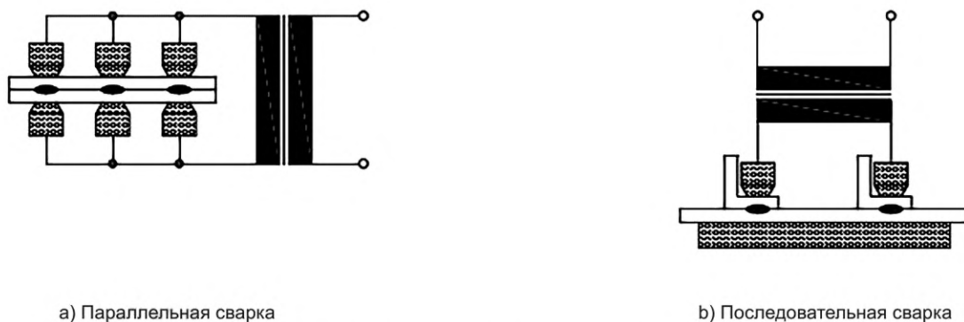
Рисунок 11 — Параллельная и последовательная точечная сварка. Односторонняя контактная сварка
