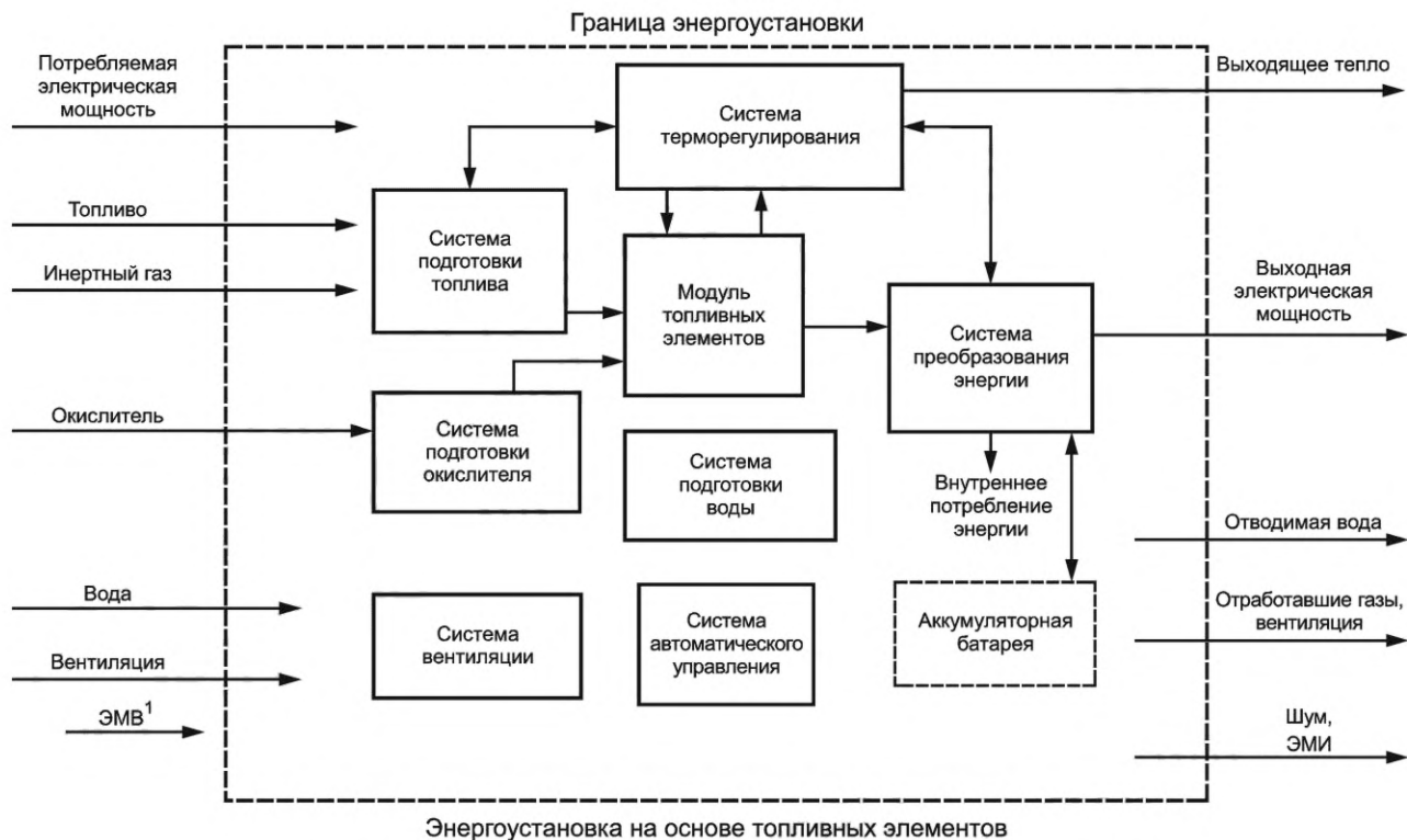
Рисунок 2 — Общая структура энергоустановки на основе топливных элементов
