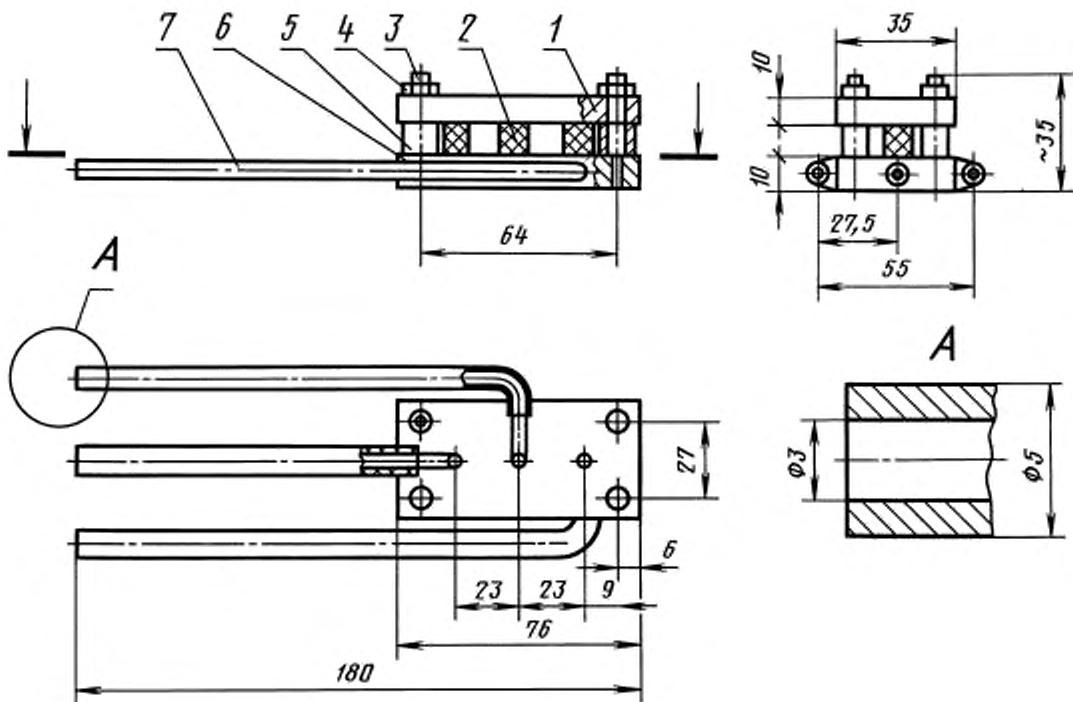
1 — верхняя плита; 2 — образец; 3 — болт; 4 — гайка; 5 — ограничитель; 6 — нижняя плита; 7 — отводная металлическая трубка
