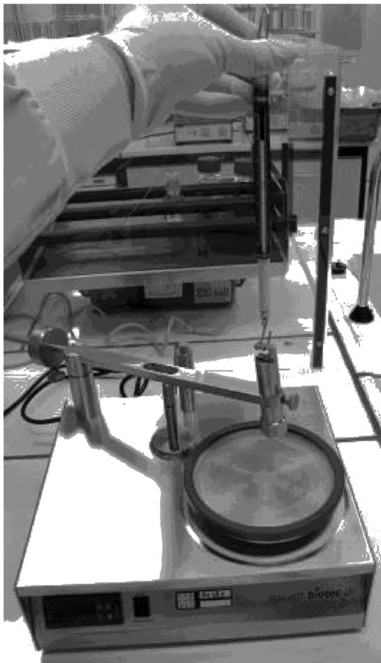
Рисунок В.3 — Регулировка силы, с которой щуп воздействует на чашку с агаровой средой
