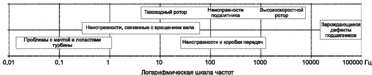
Рисунок 5 — Типичные области спектра, по которым определяют виды отказов ветрогенератора
