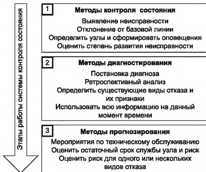
Рисунок 3 — Соотношение методов контроля, диагностирования и прогнозирования
