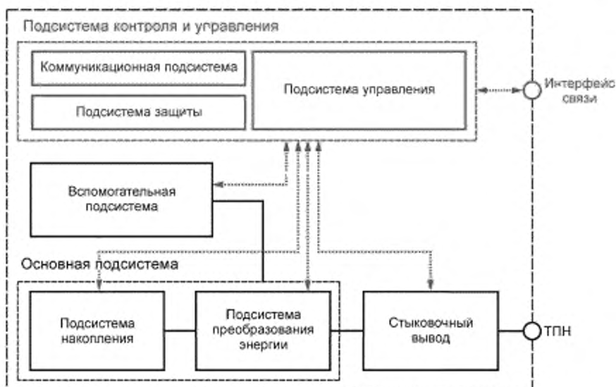
Рисунок 2 — Типовая архитектура СНЭЭ
