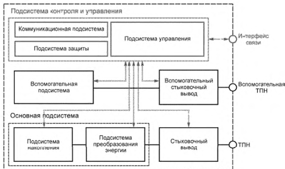
Рисунок 3 — Типовая архитектура СНЭЭ со вспомогательной ТПН
