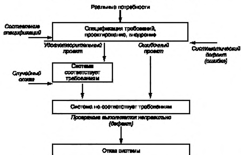
Рисунок 3 — Связь между отказом системы, случайным отказом и систематическим дефектом
