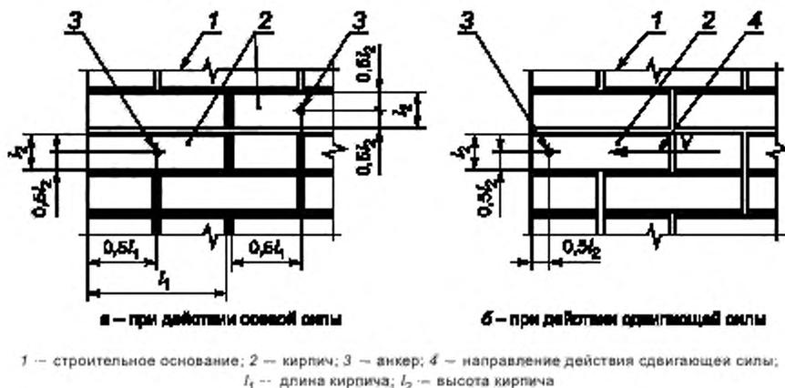
Рисунок 4 — Схема установки анкеров в основании из кирпича
