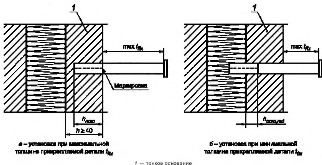
Рисунок 5 — Допустимые варианты установки пластиковых анкеров в основании
