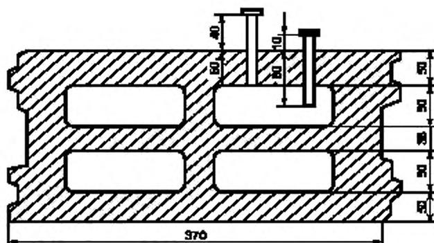
Примечание — Для примера рассмотрен анкер общей длиной 90 мм, рассчитанный на максимальную толщину прикрепляемой детали 40 мм ( $\max t_{\text{пр}} = 40$  мм).
