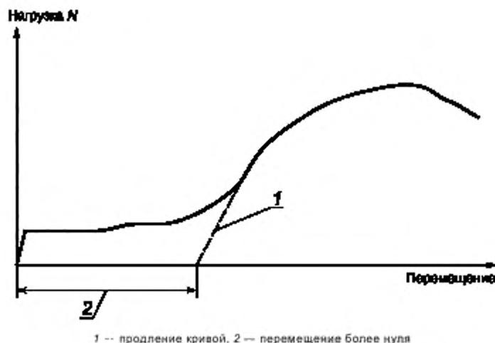
Рисунок 10 — Графики «нагрузка — перемещение» при неконтролируемом скольжении
