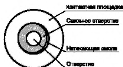
Рисунок 38 б — Горизонтальный микрошлиф
