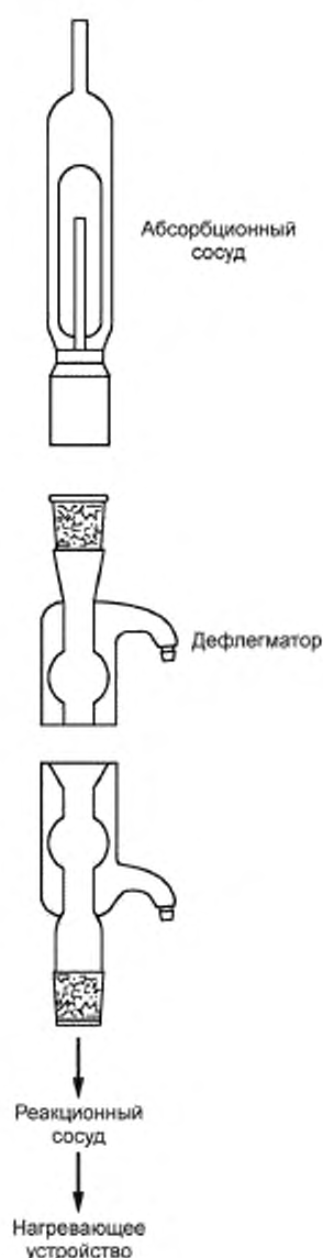
Рисунок А.1 — Нагревательный реактор, оснащенный реакционным сосудом, дефлегматором и абсорбционным сосудом
