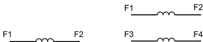
Рисунок 21 — Независимая обмотка возбуждения, один и два элемента
