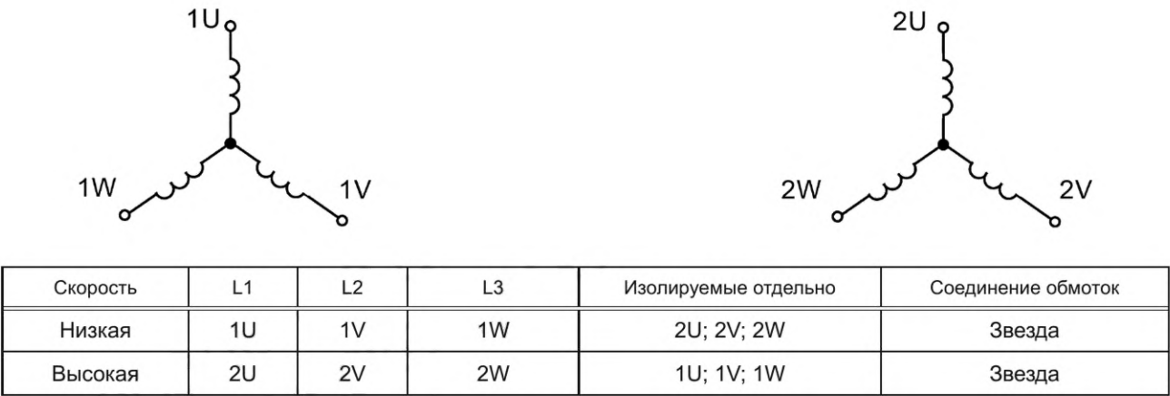
Рисунок А.14 — Переменный крутящий момент, шесть выводов
