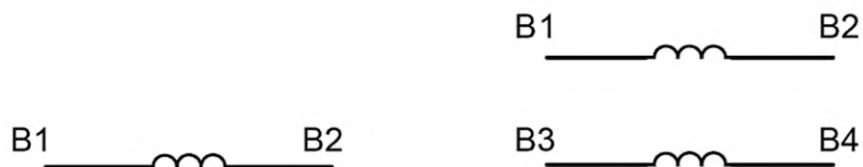
Рисунок 17 — Коммутационная обмотка, один и два элемента
