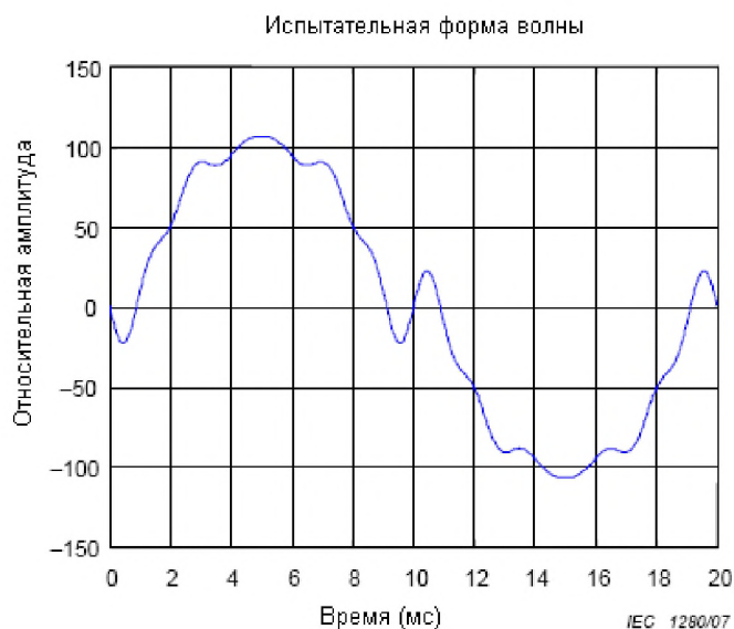
Рисунок 9 – Форма волны для испытания влияния гармоник на измерение частоты
