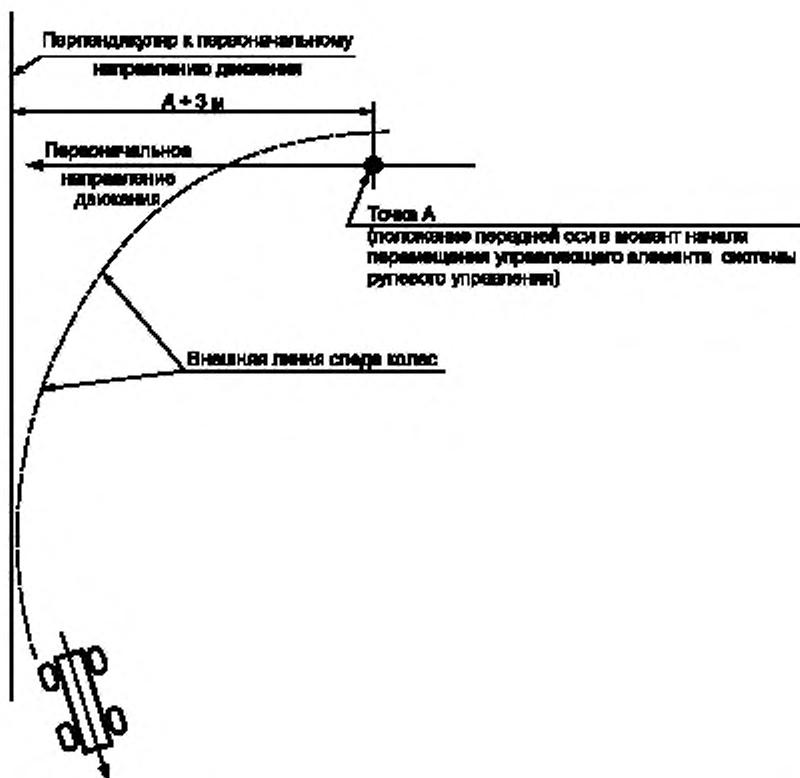
$A$  — расстояние, в 1,1 раза превышающее диаметр окружности поворота по следу колес, или 14 м в зависимости от того, какой из размеров больше
