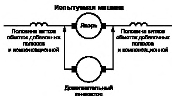
Рисунок 5 — Дополнительный генератор, используемый для увеличения или отведения части тока якоря
