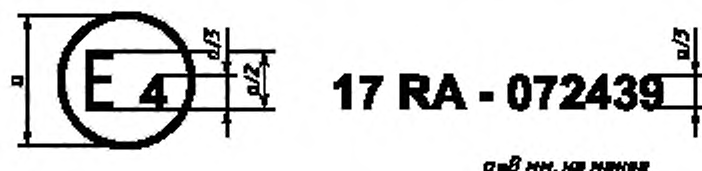
Рисунок 2.1 — Знак официального утверждения транспортного средства, оборудованного одним или более сиденьями, на которых установлены (или могут быть установлены) подголовники
