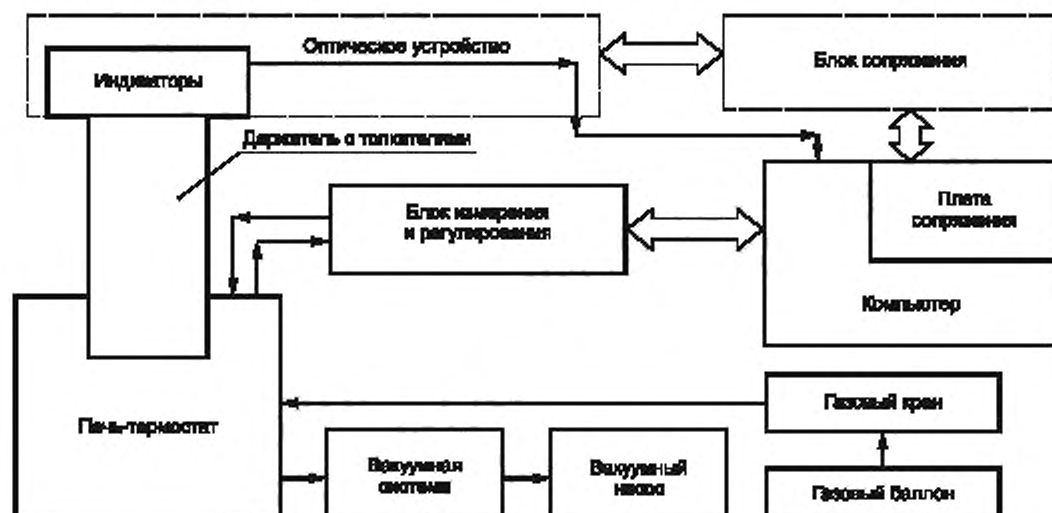
Рисунок А.1 — Функциональная блок-схема ВДТ
