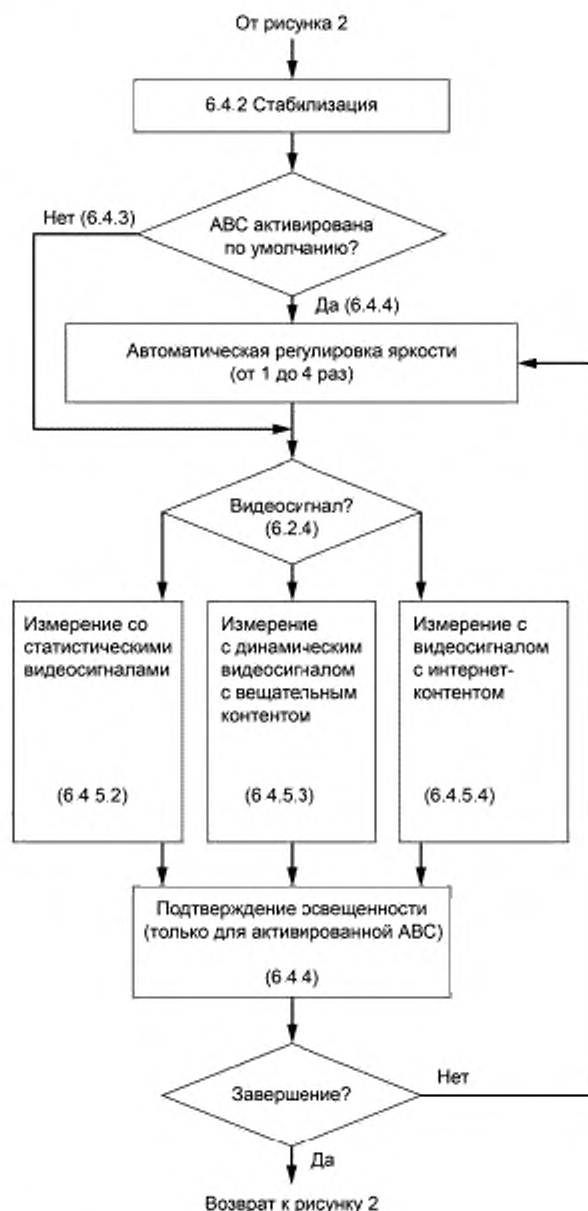
Рисунок 5 — Последовательность действий при определении потребления энергии в режиме «Вкл.»
