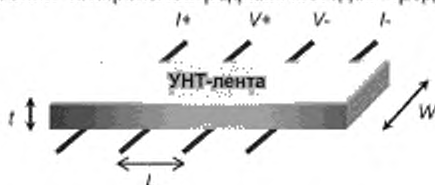
Рисунок 4 — Схема проведения измерений четырехэлектродным методом
