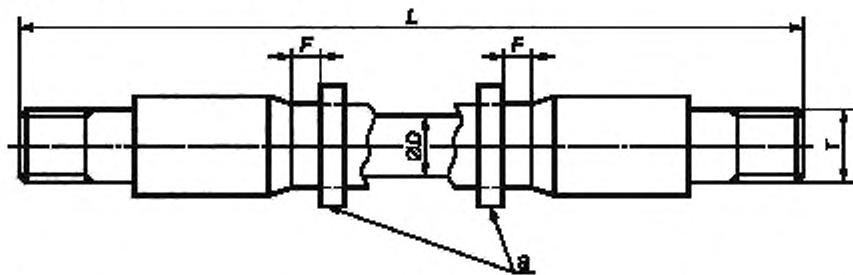
а) Изготовители должны наносить маркировку на рукава: «Зажим безопасности присоединять здесь».
