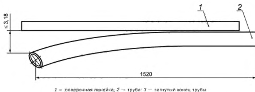
Рисунок В.2 — Измерение отклонения от концевой прямолинейности
