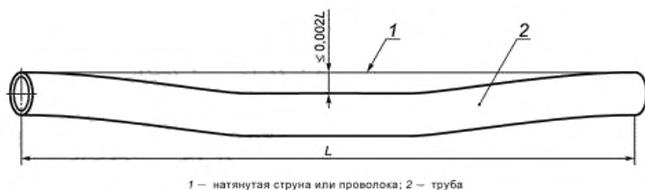
Рисунок В.1 — Измерение отклонения от общей прямолинейности
