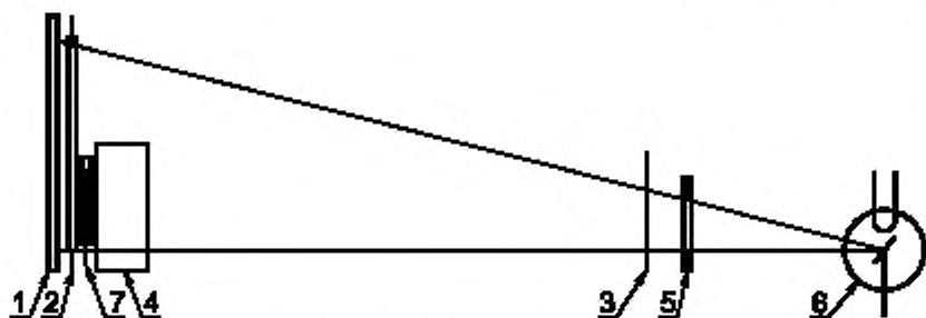
1 — система экран-пленка; 2 — вторичная ДИАФРАГМА; 3 — дополнительный слой ослабления/ФАНТОМ (например 0,8 мм Си); 4 — дентальный ФАНТОМ (см. рисунок 6); 5 — первичная ДИАФРАГМА; 6 — РЕНТГЕНОВСКАЯ ТРУБКА; 7 — детектор КЕРМАМЕТРА
