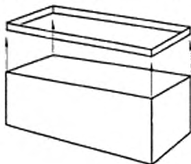
Рисунок 2 — Подъем спредером за верхние угловые фитинги
