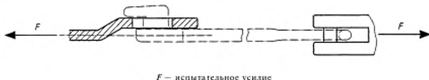
Рисунок Г.8 — Испытание контейнерной штанги на растяжение
