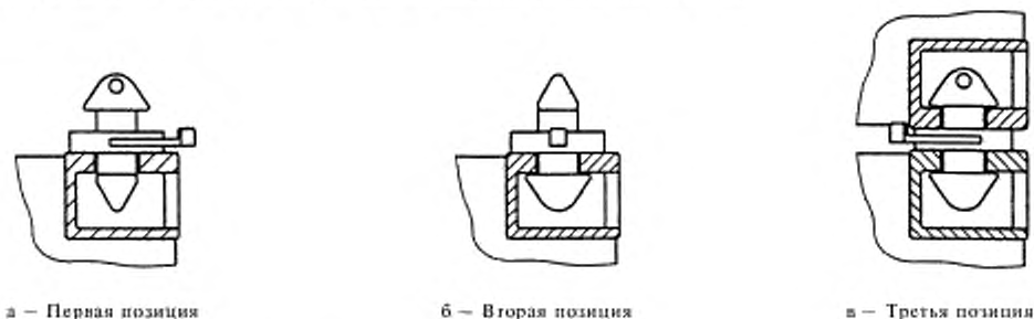
Рисунок А.2 — Ручной стопор трехпозиционный с двумя поворотными головками
