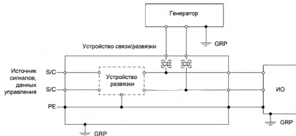
Рисунок 11a — Испытательная установка, снабженная опорной пластиной заземления (GRP)
