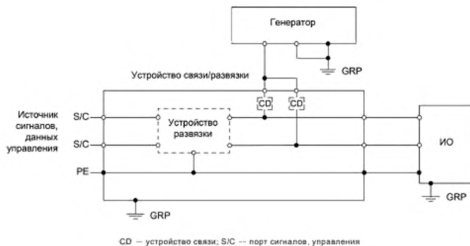
Рисунок 7a — Испытательная установка, снабженная опорной пластиной заземления (GRP)
