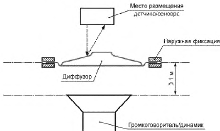
Рисунок 2 — Измерение наименьшей резонансной частоты f_0
