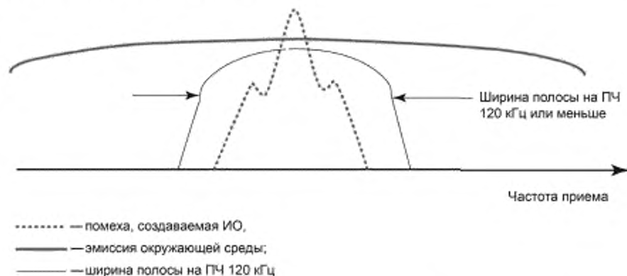
Рисунок А.9 — Амплитудно-модулированная помеха от ИО (точечная кривая)
