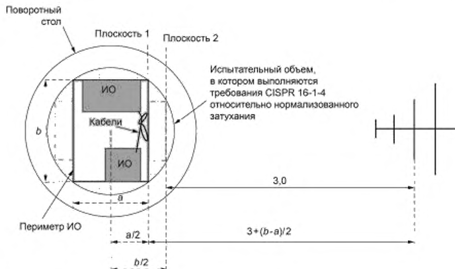
Рисунок 10 — Положение опорных плоскостей при калибровке однородного поля (вид сверху)
