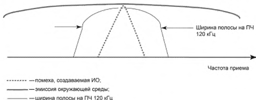
Рисунок А.8 — Немодулированная помеха от ИО (точечная кривая)
