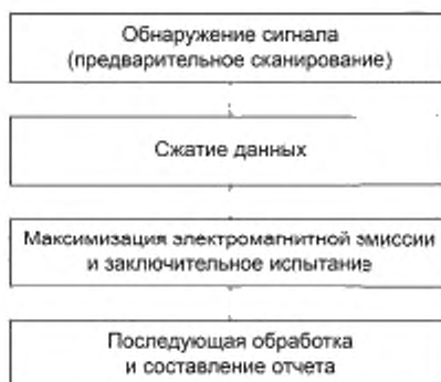
Рисунок 19 — Процесс, обеспечивающий уменьшение времени измерения
