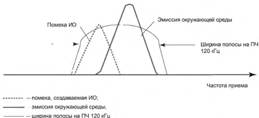
Рисунок А.3 — Помеха, создаваемая немодулированным сигналом (точечная кривая)
