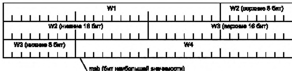
Рисунок 28 — Формат пакета 24 бита × 4 аудиосигнала W1, W2, W3, W4: 24-битовые аудиоданные формата raw
