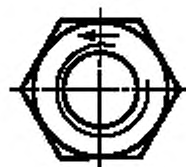
Рисунок 6 — Маркировка левой резьбы
