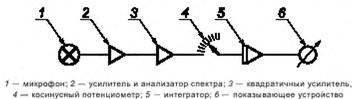
Рисунок G.3 — Пример цепи преобразования сигнала микрофона
