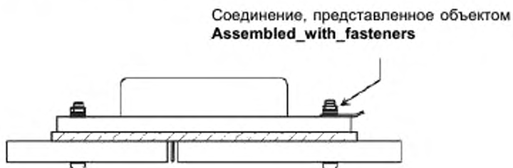
Рисунок 2 – Соединение, представленное объектом Assembled_with_fasteners
