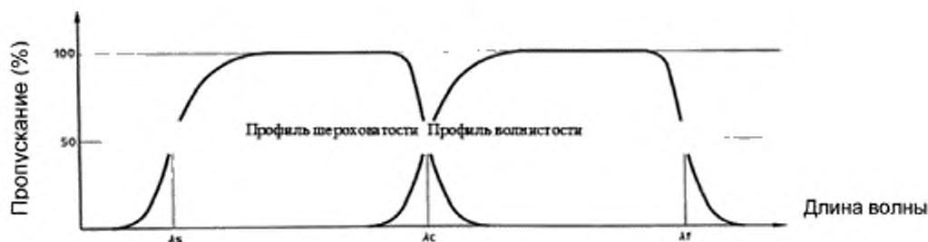
Рисунок 1 — Характеристики передачи профилей шероховатости и волнистости
