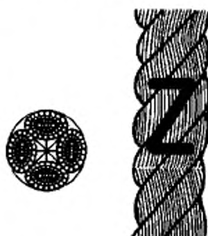
Рисунок 2 — Конфигурация 4-рядного крученого каната (тип В)
