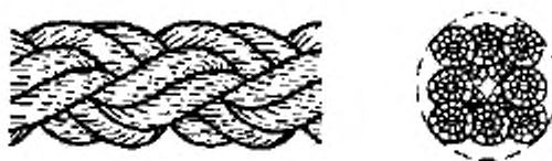
Рисунок 3 — Конфигурация 8-рядного плетеного каната (тип L)
