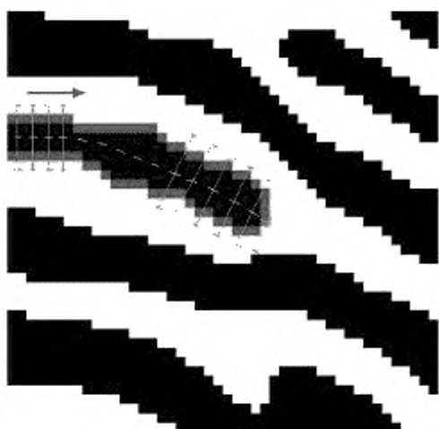
Рисунок F.13 — Расположение контрольной точки окончания остова гребня
