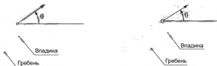
Рисунок F.16 — Направление контрольных точек окончания и бифуркации остова гребня, эквивалентно рисункам 2 и 3 из 6.4
