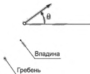
Рисунок 4 — Расположение контрольной точки окончания остова гребня
