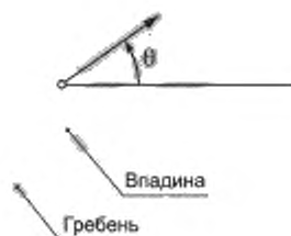
Рисунок 2 — Расположение и направление контрольной точки окончания гребня (закодированной в качестве точки бифуркации остова впадины)
