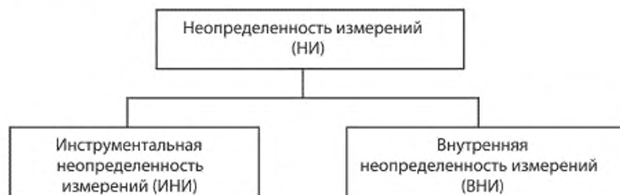
Рисунок 1 — Классификация компонентов неопределенности, связанных с экспериментальной оценкой неопределенности в испытаниях и измерениях ЭМС
