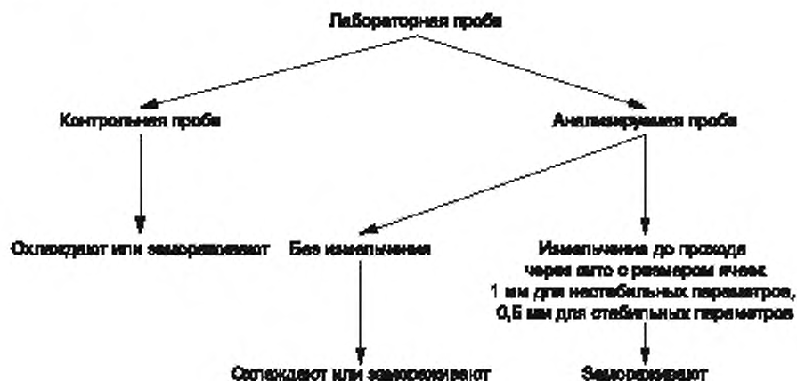
Рисунок 15 — Схема подготовки проб премиксов
