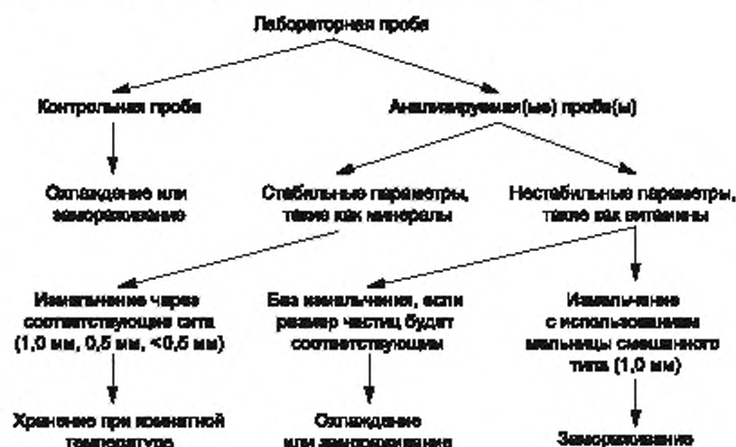
Рисунок 6 — Схема подготовки проб минеральных смесей
