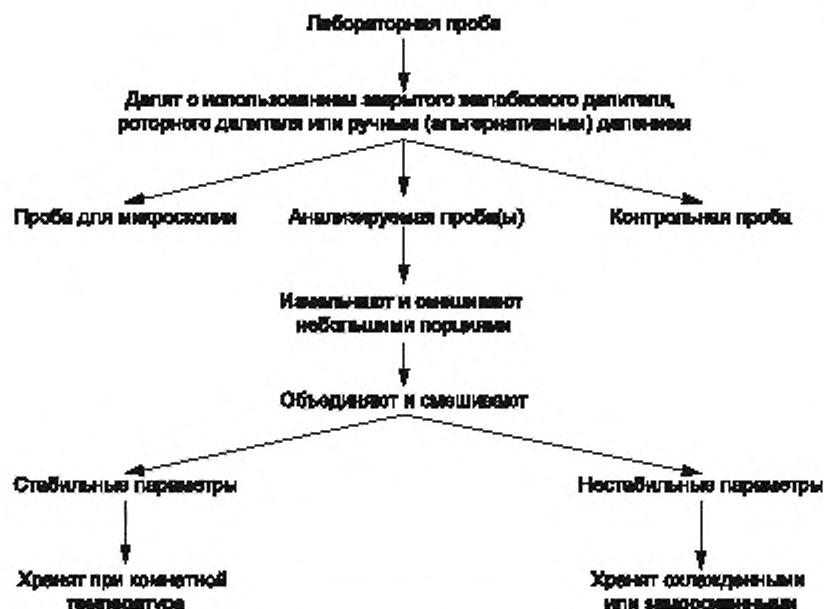
Рисунок 9 — Схема подготовки проб семян масличных культур и кормов с высоким содержанием жира
