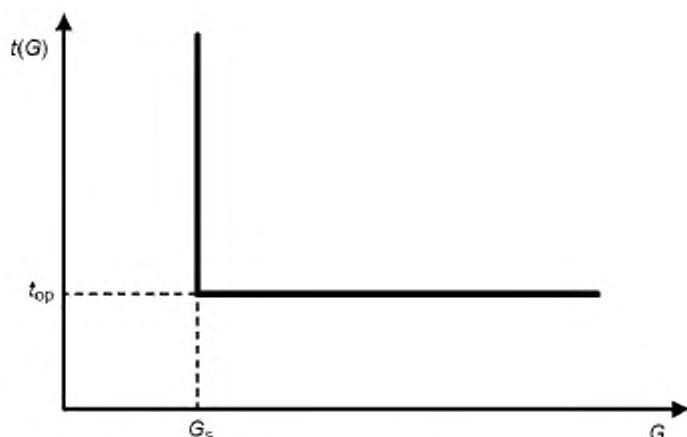
Рисунок 2 — Независимая характеристика времени реле сверхнапряжения
