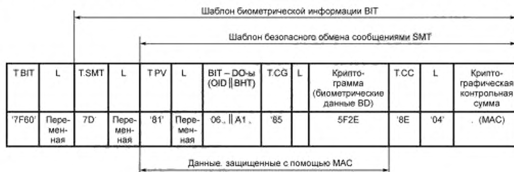
Рисунок D.2 — Шаблон BIT со встроенным SMT (пример)
