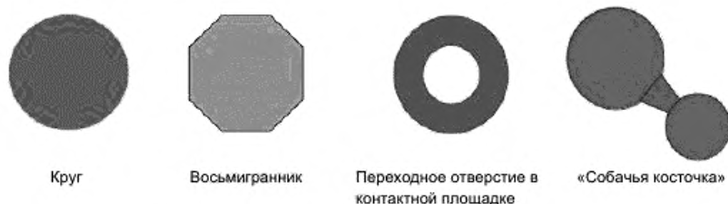
Рисунок 1 — Формы контактных площадок матричных посадочных мест
