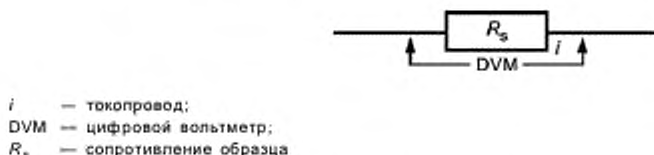
Рисунок 23 — Схема измерения контактного сопротивления
