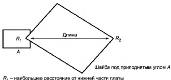
Рисунок 9 — Схема проведения измерения скручивания
