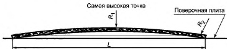
Рисунок 8 — Схема проведения измерения изгиба
