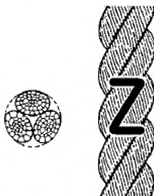
Рисунок 1- Конфигурация 3-рядного крученого каната (тип А)
