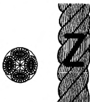
Рисунок 2- Конфигурация 4-рядного крученого каната (тип В)
