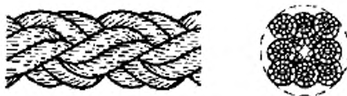
Рисунок 3-Конфигурация 8-рядного плетеного каната (тип L)
