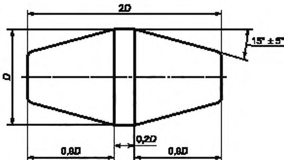
$D$  — 80 % минимального внутреннего диаметра трубной системы, указанного изготовителем
