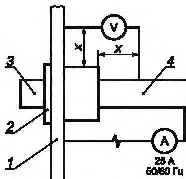
$X = (12 \pm 2)$  мм; 1—3 — миллиметровая стальная пластина; 2 — дополнительная натяжная тайка, 3 — концевая трубная арматура, прикрепленная к пластине сквозным болтом или на резьбе самой арматуры; 4 — труба
