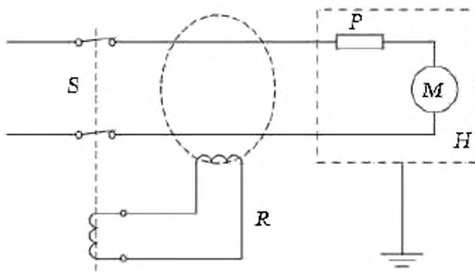
S — источник питания; H — корпус; R — защитное устройство с остаточным током ( $I_{st} = 30 \text{ мА}$ ); P — устройство тепловой защиты двигателя (внешнее и внутреннее), если имеется; M — двигатель
