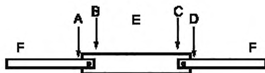
A-B, C-D — точки измерения сопротивления контактных соединений; E — сплошной проводник или многопроволочный витой проводник, соответствующий МЭК 62561-2, F — проводник системы молниезащиты, соответствующий МЭК 62561-2
