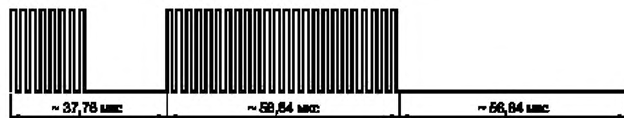
Рисунок 16 — Конец кадра при использовании одной поднесущей
