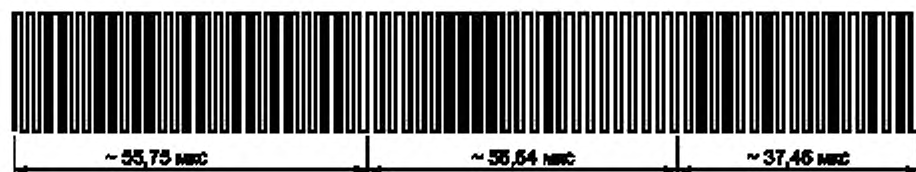
Рисунок 15 — Начало кадра при использовании двух поднесущих
