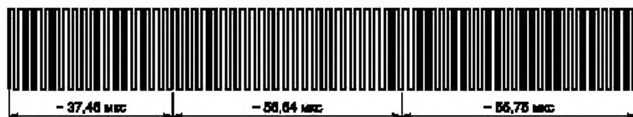
Рисунок 17 — Конец кадра при использовании двух поднесущих
