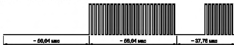
Рисунок 14 — Начало кадра при использовании одной поднесущей
