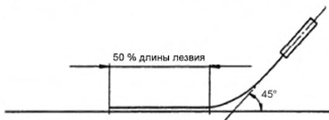
Рисунок 2 — Испытания на прочность лезвия
