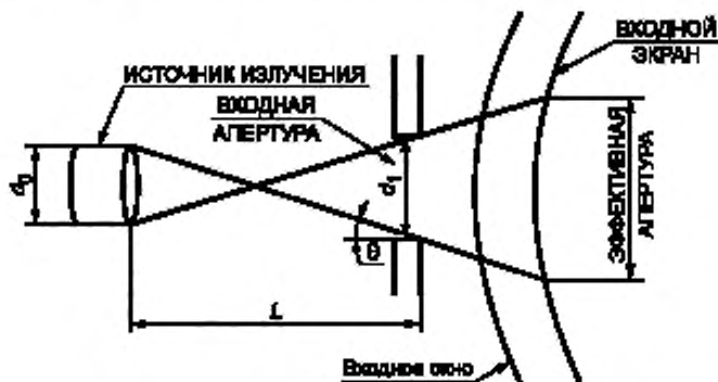
Рисунок 1 — Схема расположения ИСТОЧНИКА ИЗЛУЧЕНИЯ и ВХОДНОЙ АПЕРТУРЫ
