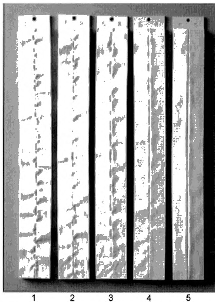
Рисунок 4 — Фотография сравнительной шкалы на пластмассовых эталонах для одинарных швов
